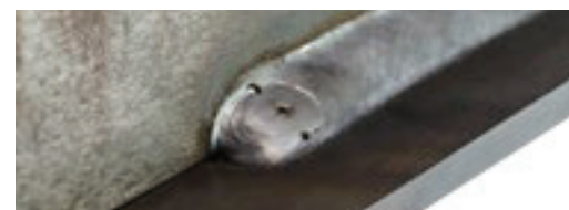
Mit Endkraterfüllung – perfektes Nahtende.
