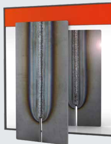
Beim Wurzelschweißen zählt vor allem, was man sonst nicht sieht: Im Spiegel die Nahtvorderseite (links) und die Nahtrückseite (rechts).
