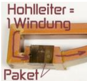
Bild: Der Aufbau der Induktorspitze mit Hohlleiter und dem offenen Transformatorpaket.
