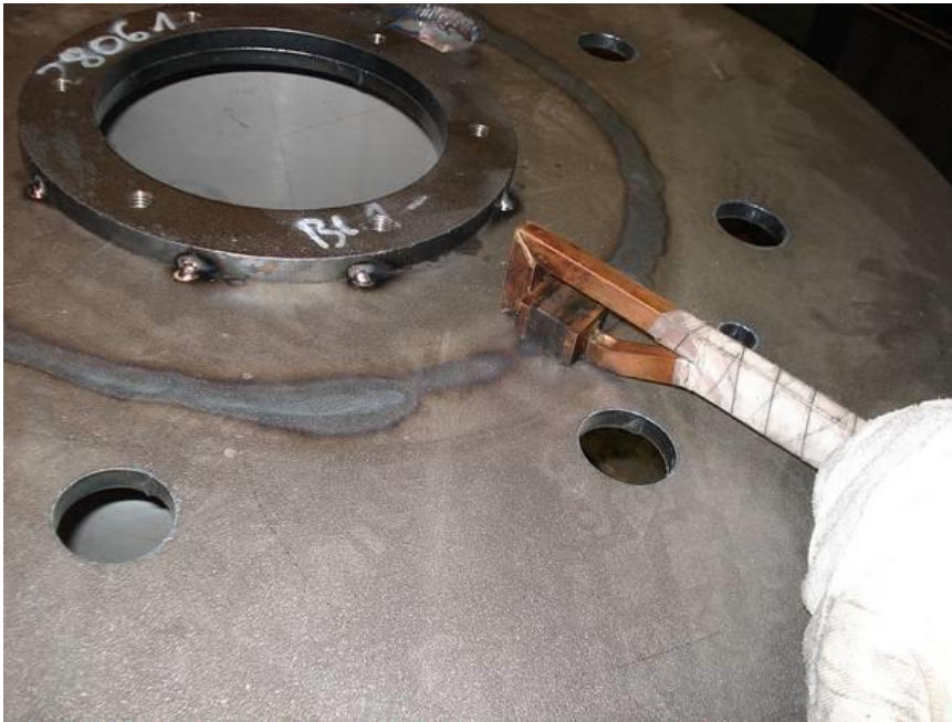
Bild: Spannungsfrei wärmen mit Induktion
