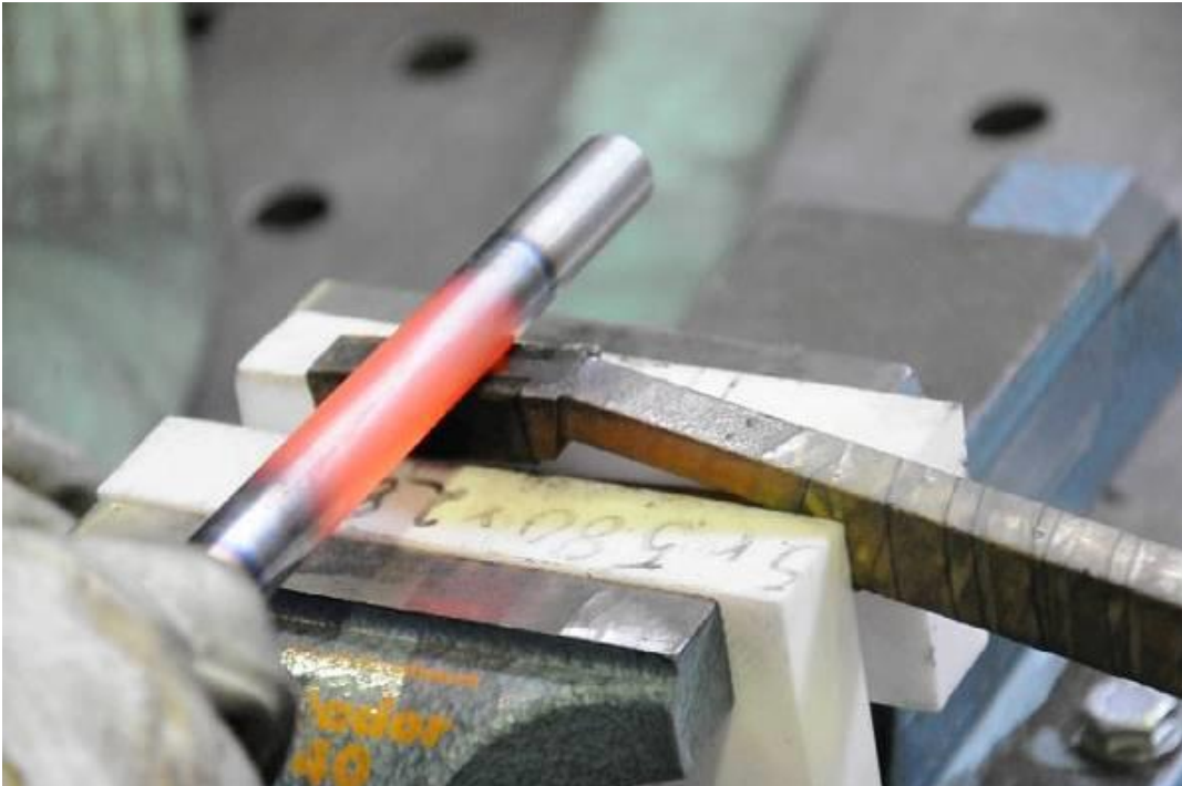
Bild: Die Welle wird mit Induktion in den plastischen Bereich geblüht und dann gebogen!
