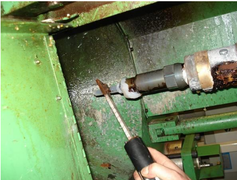
Kunststoffpfropf lösen an Kaltkanal-Spritzgussmaschine
