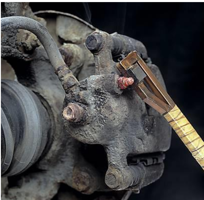
Die einfachste Anwendung: Entlüftungsnippel am Bremssattel!
