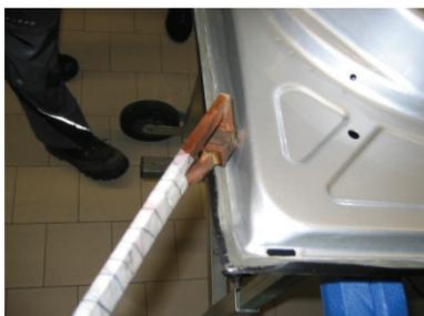
Bild: Türblattverklebung lösen
