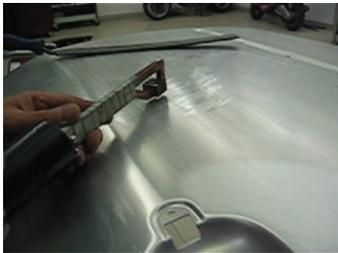
Bild: Erwärmen mit Induktion
