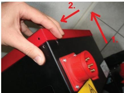
Danach heben Sie wie links gezeigt das hintere Ende des roten Deckelblechs an (1.) und schieben es dann nach vorne aus seiner Halterung heraus (2). Achtung, Sie können das Blech nicht ganz abnehmen, da das Flachbandkabel der Anzeige noch verbunden ist. Hinweis: Die zwei Torx-Schrauben auf der Unterseite gelten nur als Transportsicherung und werden nicht wieder eingesetzt.
