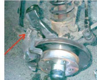
Bild: Überwurfmutter an der Bremsleitung
