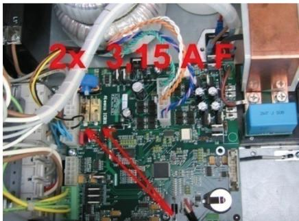
Sie sehen nun die Haupt-Leiterkarte, darauf zwei Halterungen für Feinsicherungen. Sie werden wahrscheinlich feststellen, dass beide Sicherungen durchgebrannt sind. In diesem Fall durch Sicherungen Größe 5x20, Stärke 3,15A, Auslösecharakteristik 'MT' ersetzen.
