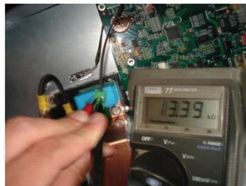
abgezogenem Netzstecker die Haube und ziehen den grünen zweipoligen Stecker ab. Wenn das Gerät jetzt wieder funktioniert, bestellen Sie ein neues Thermoelement.
