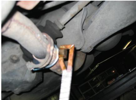
Bild: Zusammengesteckte, festgerostete Auspuffteile trennen
