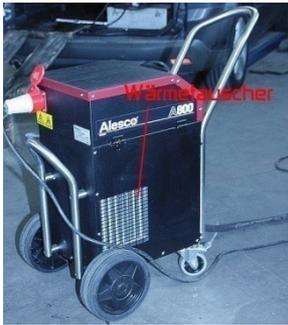
Bild: Die Wärmetauscher-Fläche auf der Aussenseite
