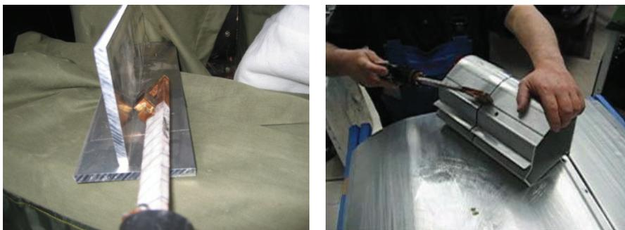
Bild: Erwärmen von Aluminium für Schweissarbeiten
