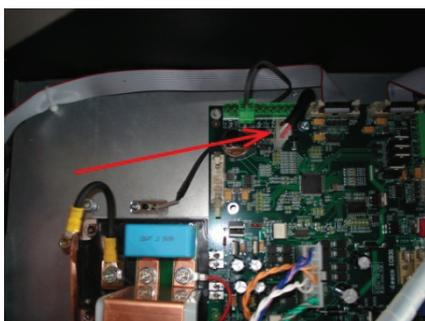
In seltenen Fällen könnte auch die Verbindung auf der Haupt-Leiterkarte nicht richtig stecken, der entsprechende Stecker wird hier links gezeigt. Dazu muss wie zu Beginn des Kapitels beschrieben das Deckelblech geöffnet werden. Beachten Sie die entsprechenden Sicherheitshinweise.
